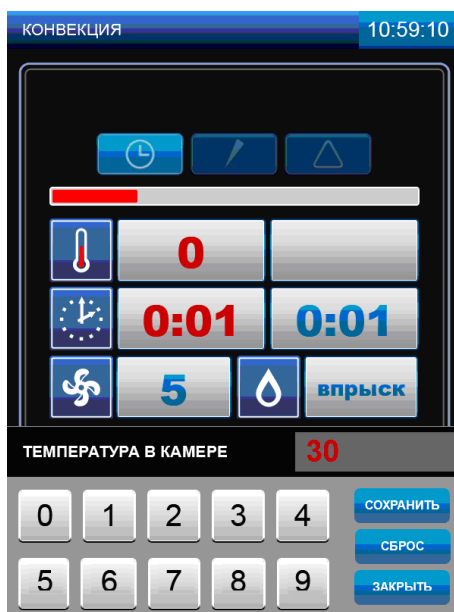
Рис. 12. Редактирование параметра « ТЕМПЕРАТУРА В КАМЕРЕ »
